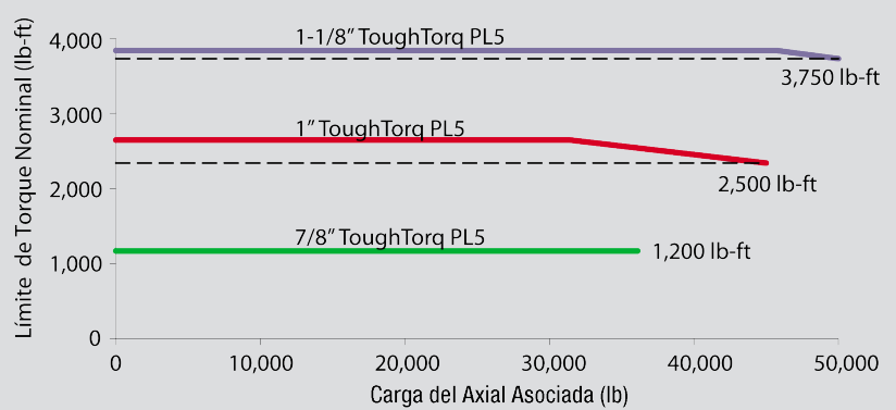
Limite de Torque Nominal vs. Carga del Axial Asociada 2,3,4,6
